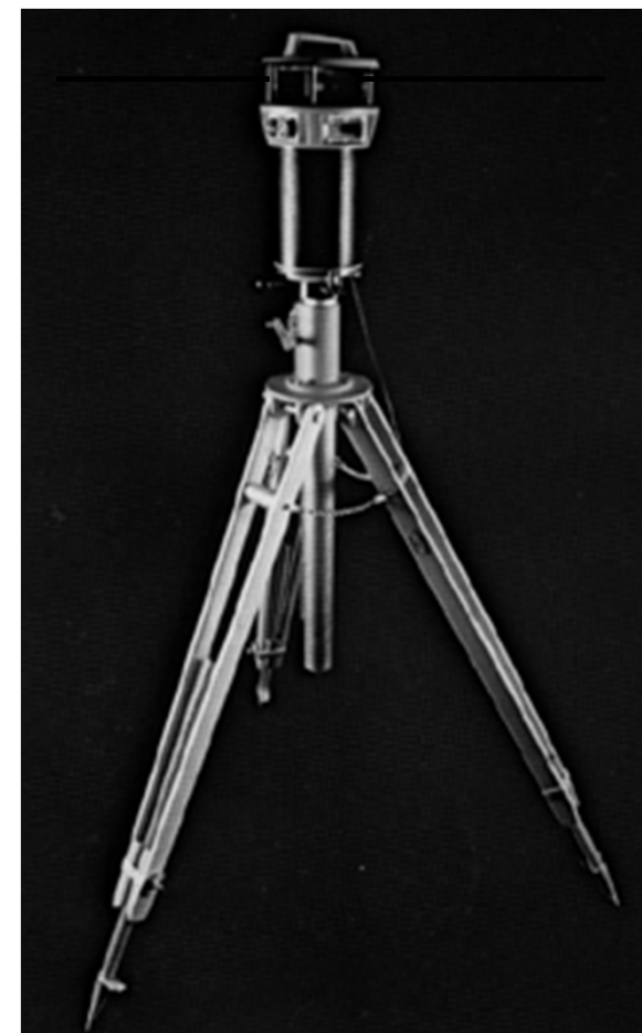
Tipico strumento a livella laser montato su un treppiedi 12/38
